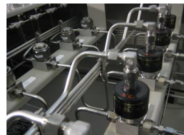
サンプリング盤 (SUSチューブ6.8Φ)
